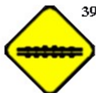
Paso a nivel con barreras
