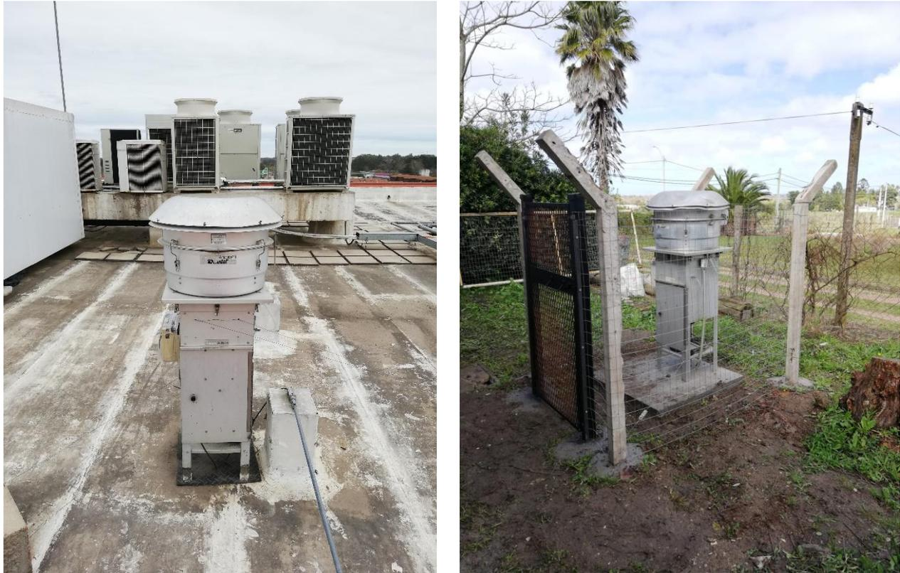
Figura 2: Equipos HiVol utilizados en el monitoreo de Ciudad de la Costa (izquierda) y Pando (derecha).
