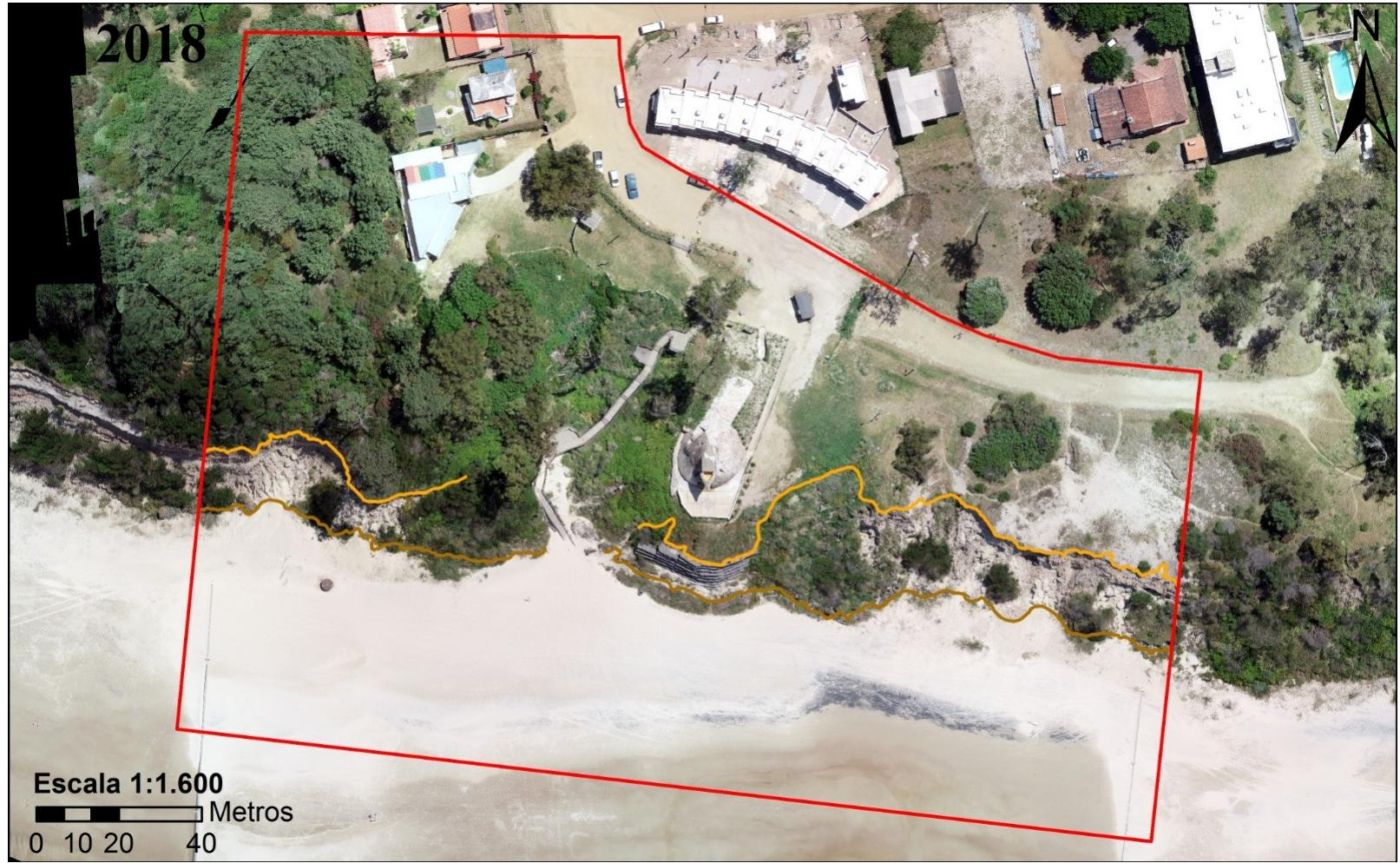
**En el barranco, existe una mayor erosión en la parte superior del lado lateral de la estructura respecto al 2011.** Mediante herramientas se aprecia un **aumento del orden de 2m** en la erosión del barranco, también hay una **visible diferencia en el límite inferior**, sobre todo en las zonas donde la **vegetación es escasa o nula**.
