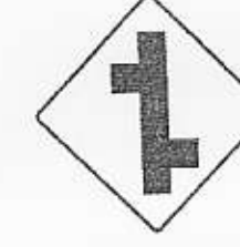
EMPALMES SUCEIVOS CONTRARIOS
