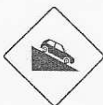
PENDIENTE PELIGROSA (BAJADA)
