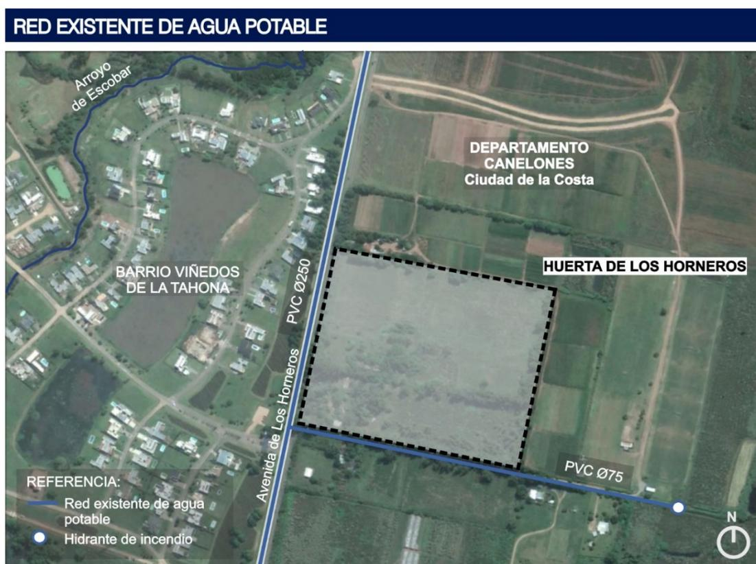
Figura 3-1 Redes de agua potable existentes en la zona del emprendimiento
